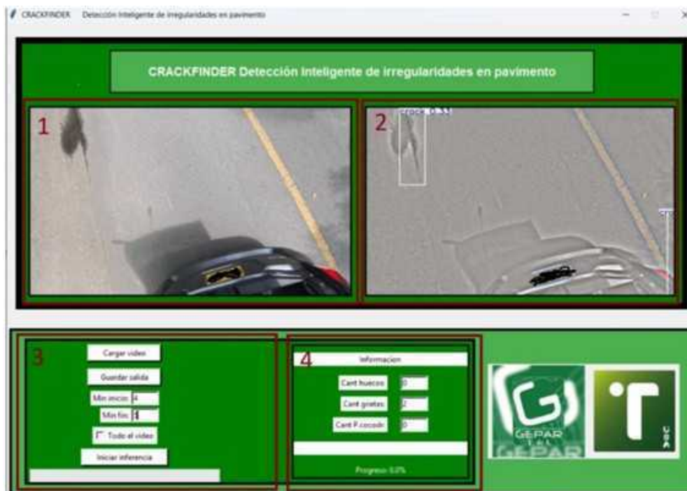
Figura 13.2: Interfaz principal de CRACKFINDER. La aplicación integra visualización del fotograma original, visualización del resultado procesado, controles de ejecución, barra de progreso y contadores de imperfecciones.
