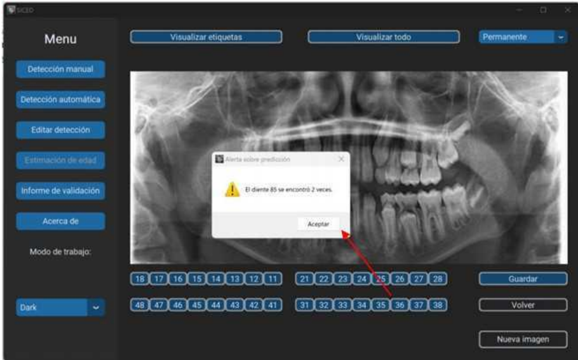
Figura 10.3: Visualización de detección automática de piezas dentales en una radiografía panorámica. El sistema segmenta las estructuras dentales, asigna etiquetas y permite su revisión posterior por parte del usuario.
