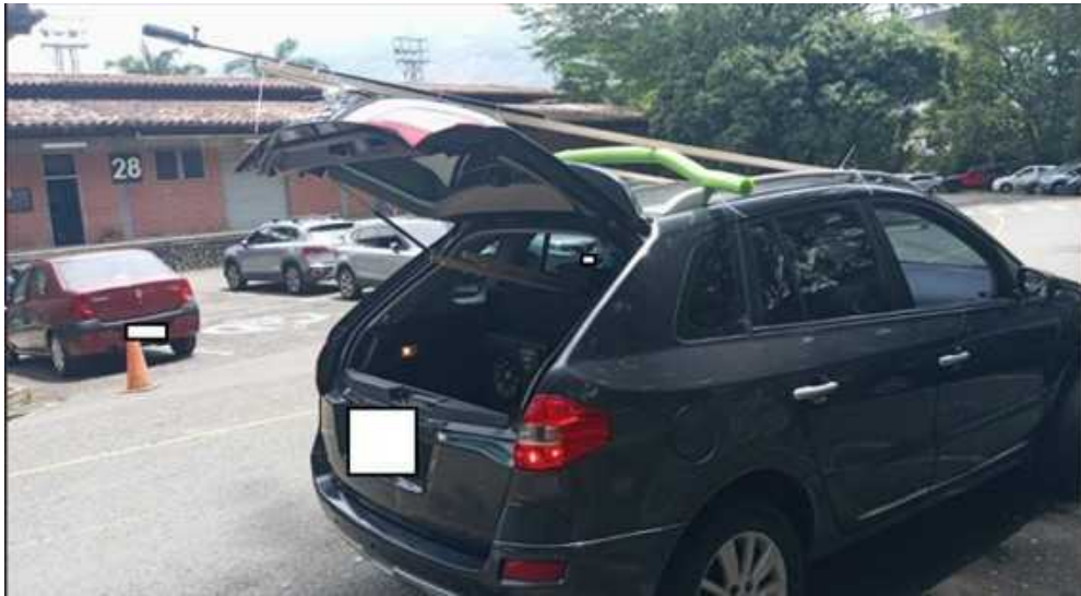
Figura 13.1: Montaje empleado para la captura de datos sobre pavimento. La cámara se instala sobre un vehículo en movimiento para registrar la superficie vial bajo una perspectiva relativamente constante.
