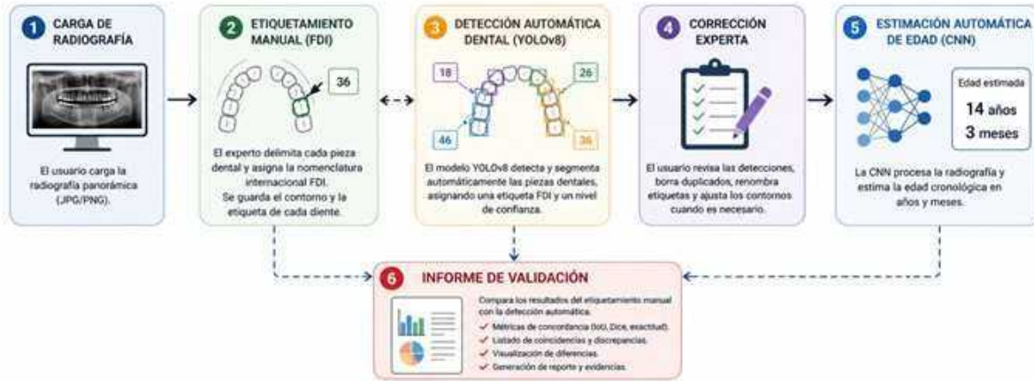
Figura 10.1: Flujo funcional del sistema para estimación forense de edad a partir de radiografías panorámicas. El proceso integra carga de imagen, etiquetamiento manual, segmentación automática mediante YOLOv8, corrección experta, estimación de edad con CNN e informe de validación entre resultados manuales y automáticos.
