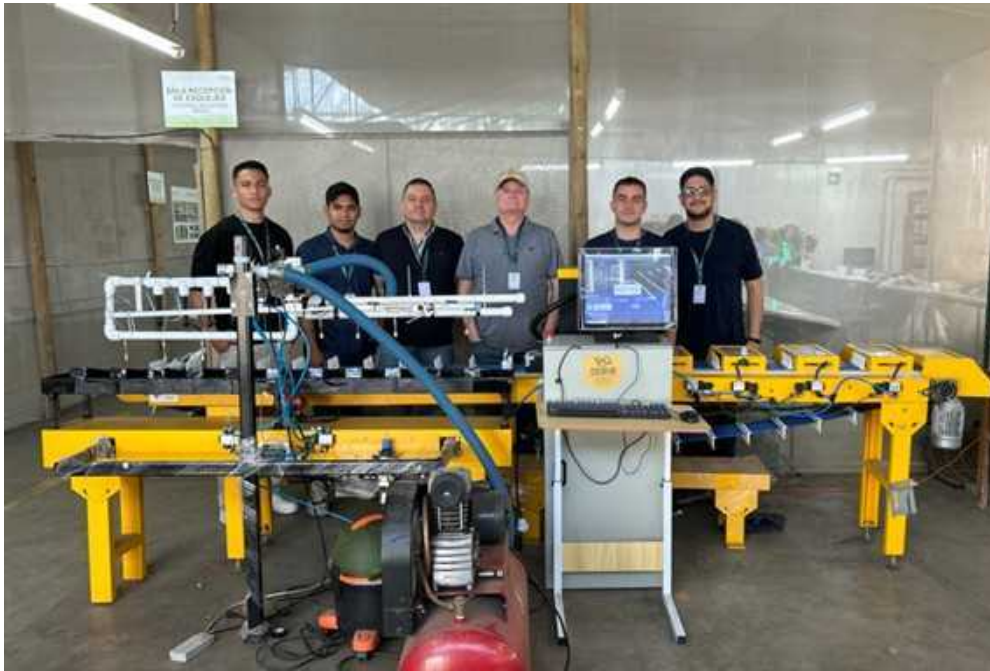
Figura 3.5: Montaje e integración del sistema, mostrando la articulación física entre alimentador, máquina seleccionadora, computador de operación y elementos de actuación.
