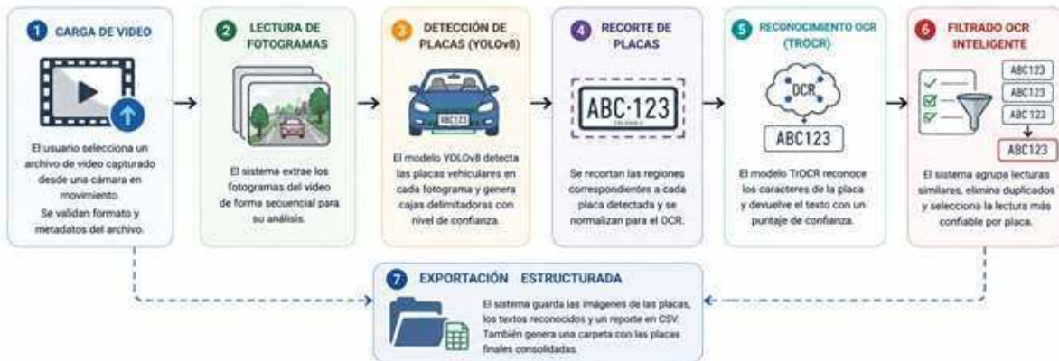
Figura 11.2: Flujo funcional del sistema para reconocimiento móvil de placas vehiculares. El procesamiento inicia con un video capturado desde una cámara en movimiento, continúa con lectura de fotogramas, detección mediante YOLOv8, recorte de placas, reconocimiento OCR con TrOCR, filtrado inteligente y exportación estructurada de evidencias.
