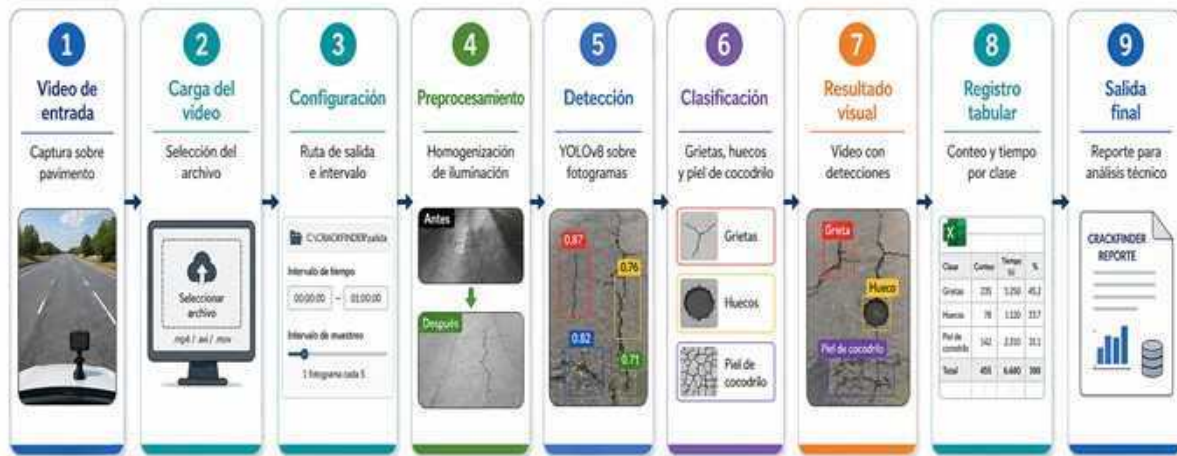
Figura 13.3: Flujo funcional de CRACKFINDER. El sistema parte de un video de entrada capturado sobre pavimento, realiza la configuración del análisis, aplica preprocesamiento e inferencia con YOLOv8, clasifica las irregularidades detectadas y genera salidas visuales y tabulares para análisis técnico.
