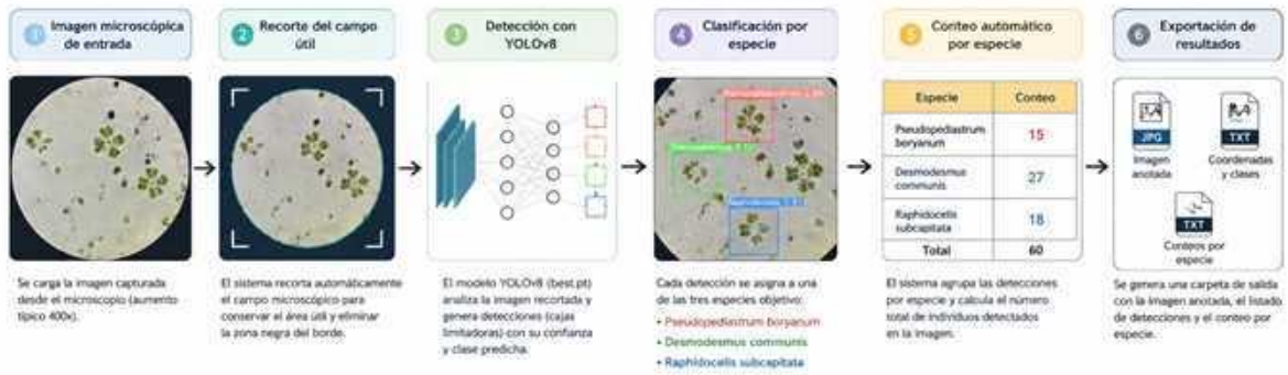
Figura 9.2: Flujo funcional del sistema para detección, clasificación y conteo de microalgas. El procesamiento inicia con la imagen microscópica, continúa con el recorte del campo útil, la inferencia con YOLO, el conteo por especie y finaliza con la generación de archivos de salida.
