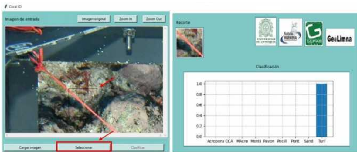
Figura 8.3: Interfaz principal del sistema, con imagen cargada, recorte seleccionado, controles de navegación y gráfico de clasificación.
