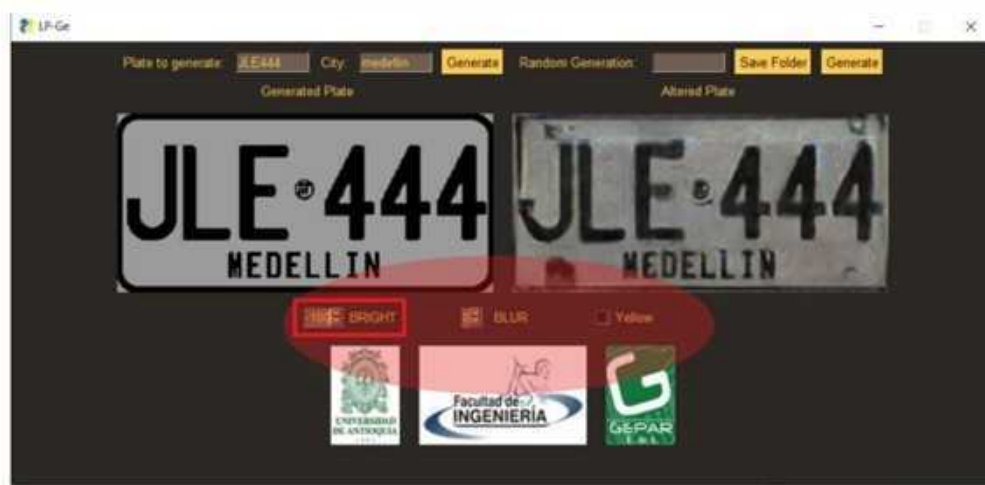
Figura 6.3: Modificadores visuales de brillo, desenfoque y color aplicados sobre placas generadas para expandir la variabilidad del dataset.
