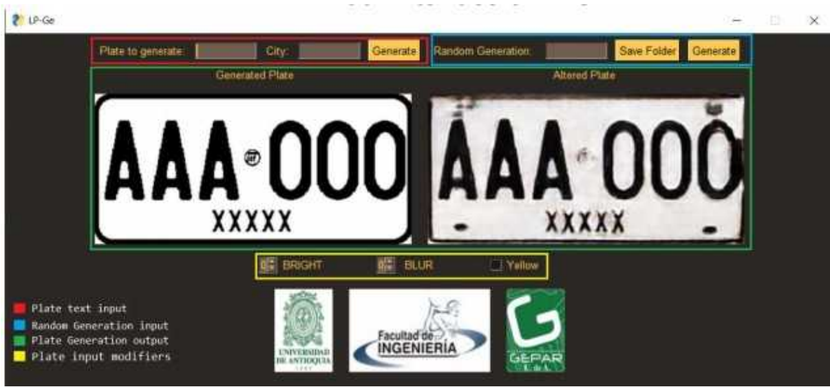
Figura 6.1: Interfaz general del generador, con construcción de la placa sintética a la izquierda y visualización de la versión realista generada a la derecha.
