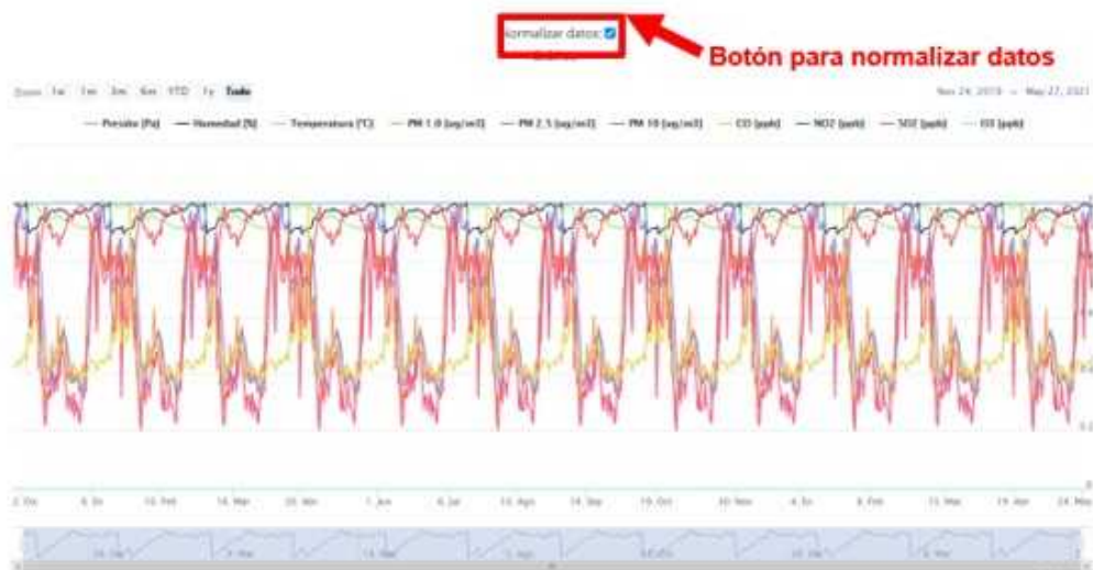
Figura 1.3: Gráfico temporal de variables en GeoVAM. Se muestra la lógica de selección de estación, exploración por periodo y comparación de variables, incluyendo la opción de normalización cuando está disponible.
