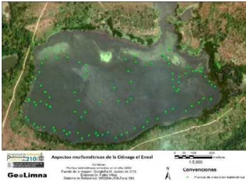
Figura 11.2: Distribución espacial de los puntos batimétricos utilizados para la reconstrucción del vaso en 2004 y 2022.
