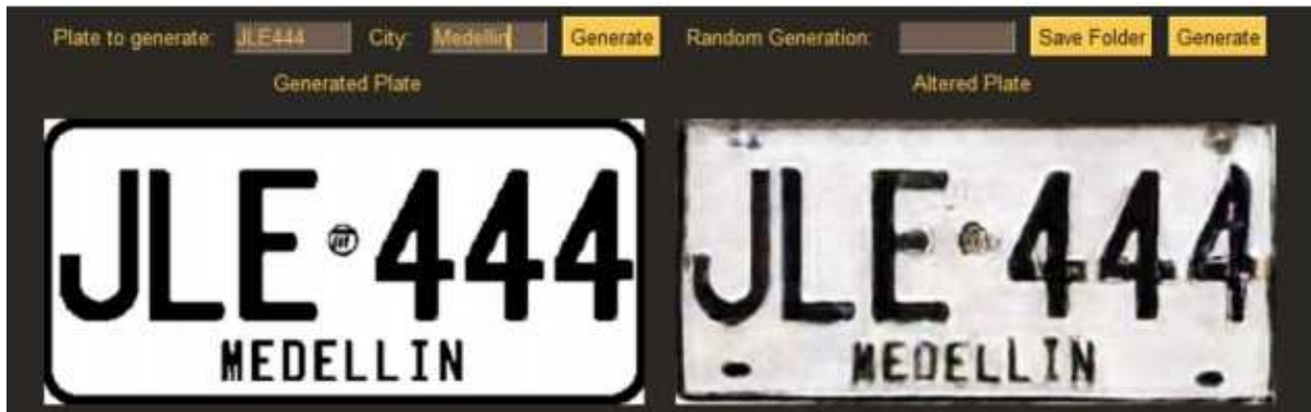
Figura 6.2: Ejemplo de generación específica de una placa, mostrando la versión sintética y su correspondiente versión alterada con apariencia realista.
