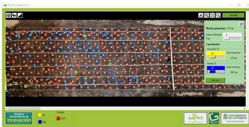
Figura 10.4: Módulo de estadísticas de SICOP Analítica. La interfaz integra la visualización de la cama con parámetros de área mínima, área máxima, área a eliminar, conteo por clases, área promedio y otras medidas de resumen útiles para la caracterización del cultivo.
