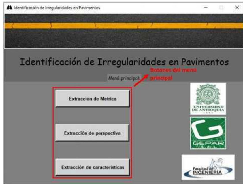
Figura 14.3: Menú principal de IDIRPA. El software organiza su funcionamiento en tres módulos secuenciales: extracción de métrica, extracción de perspectiva y extracción de características.
