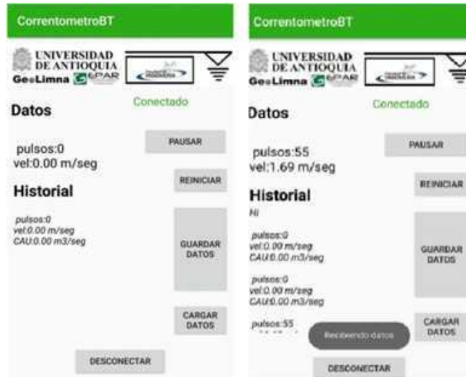
Figura 8.4: Interfaz principal de la aplicación móvil de CorrentómetroBT . Se observan el valor actual, el historial de mediciones, el estado de conexión y los controles operativos de la sesión.
