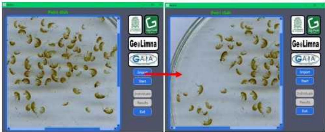
Figura 11.3: Interfaz principal de HyACS. El usuario puede importar una imagen, iniciar la ejecución, consultar resultados individuales, visualizar resultados promedio y cerrar el sistema.
