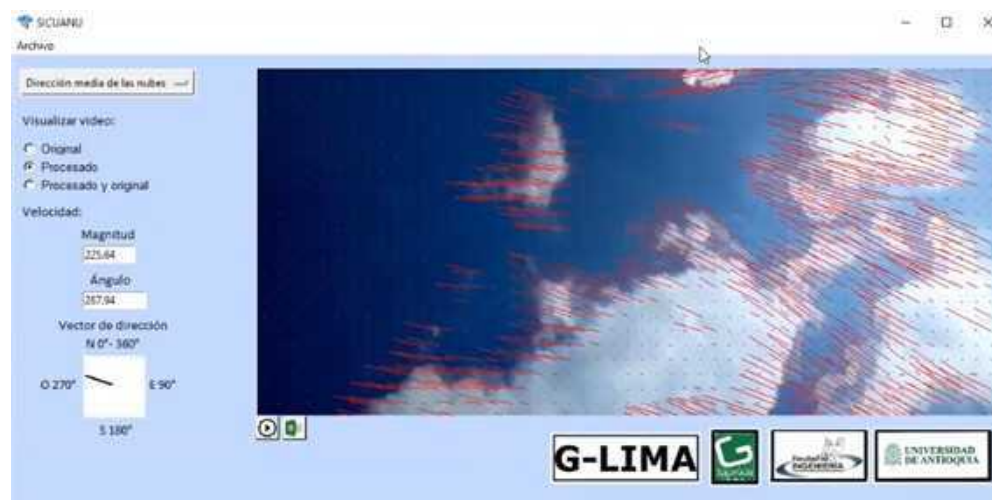
Figura 12.2: Ejemplo conceptual de secuencia de imágenes del cielo. La comparación entre cuadros permite estimar tanto la fracción nubosa como el desplazamiento aparente de las estructuras de nube en el tiempo.
