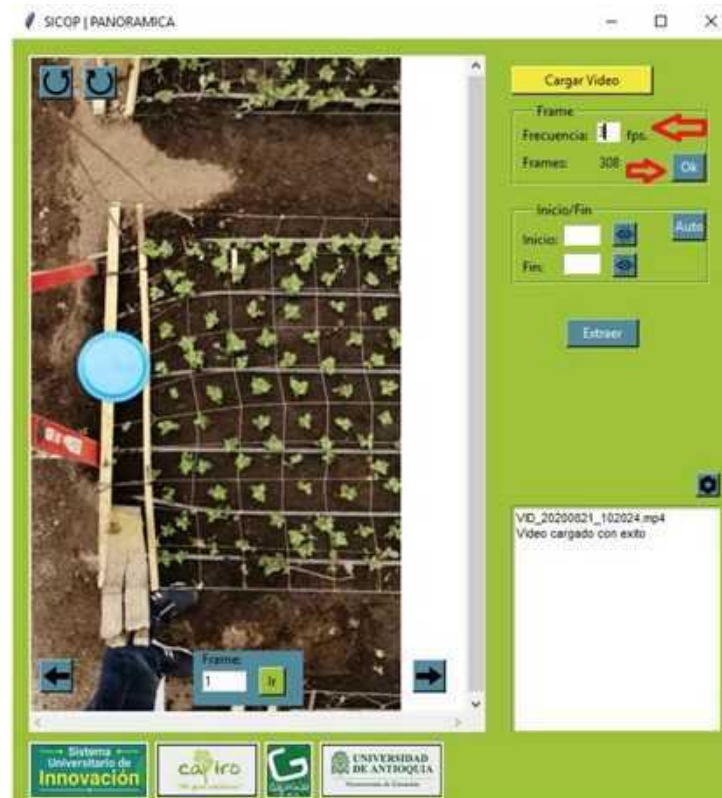
Figura 9.3: Interfaz principal de SICOP Panorámica. El usuario puede cargar el video, revisar la orientación, definir la frecuencia de muestreo, establecer los frames de inicio y fin y ejecutar la extracción que conduce a la panorámica final.
