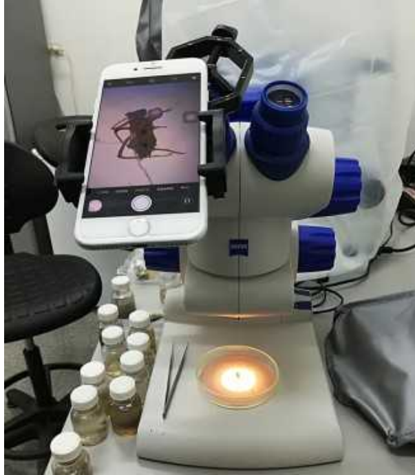
Figura 1.2: Montaje de captura de imágenes en laboratorio: microscopio Zeiss y soporte para smartphone (iPhone 12) para adquisición fotográfica estandarizada. La estabilización mecánica y la repetibilidad del encuadre reducen variabilidad intra-clase no deseada (iluminación, escala y enfoque), lo que favorece la generalización del clasificador.
