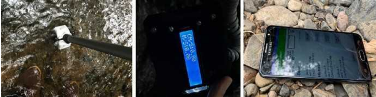
Figura 8.3: Montaje físico o disposición general del CorrentómetroBT . La figura permite apreciar la materialización del sistema y su orientación hacia un uso portátil en campañas de campo.
