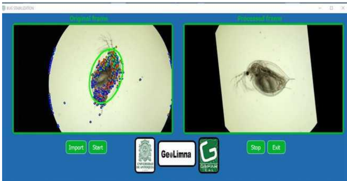
Figura 6.7: Interfaz del software ESVIDA: (izquierda) fotograma original con elipse y puntos de movimiento; (derecha) fotograma estabilizado.
