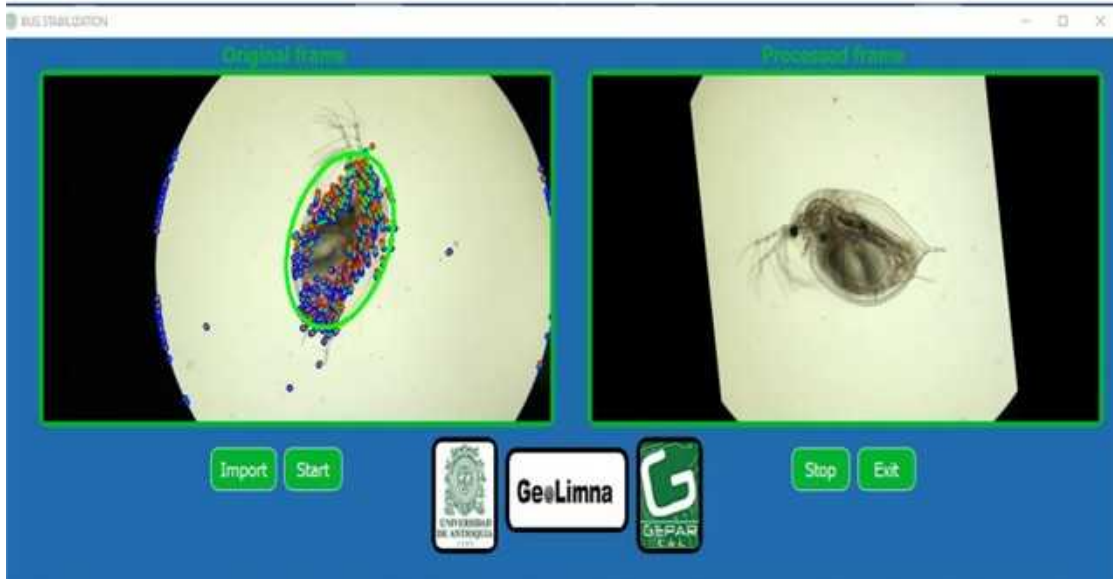
Figura 7.4: Estabilización SURF: puntos detectados y emparejados entre f_i y f_{i+1} ; el vector global \Delta\bar{p}_i se usa para compensar el movimiento del organismo. (Ver presentación de Estabilización de Imagen Pulga de Agua -ESVIDA-)
