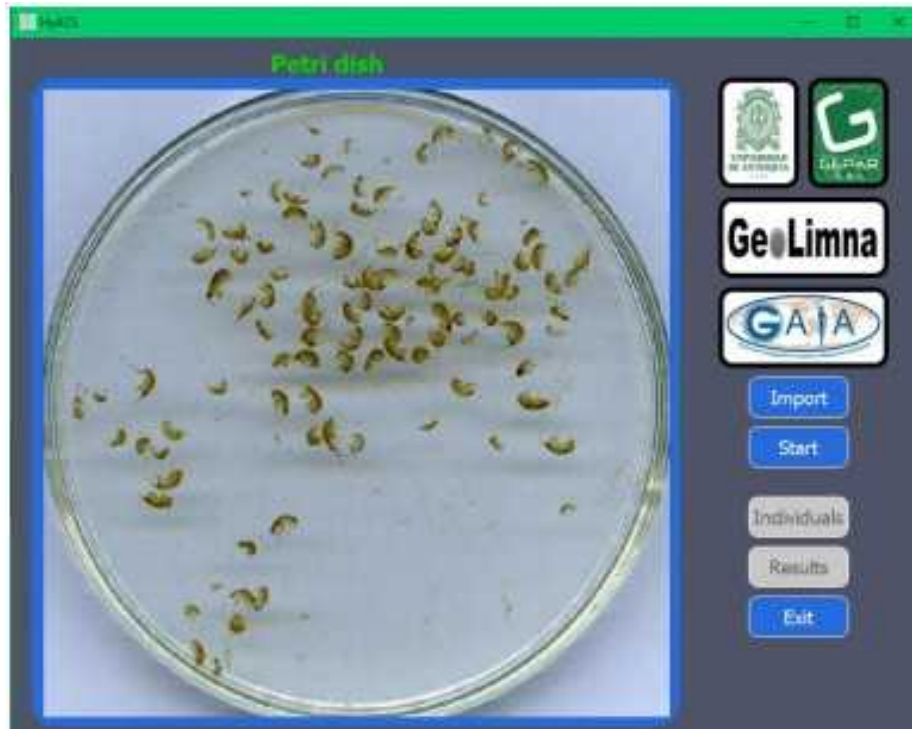
Figura 11.2: Imagen de entrada típica para HyACS: caja de Petri con múltiples individuos de Hyalella . A partir de esta escena el sistema debe localizar organismos, contarlos y extraer sus métricas morfológicas.
