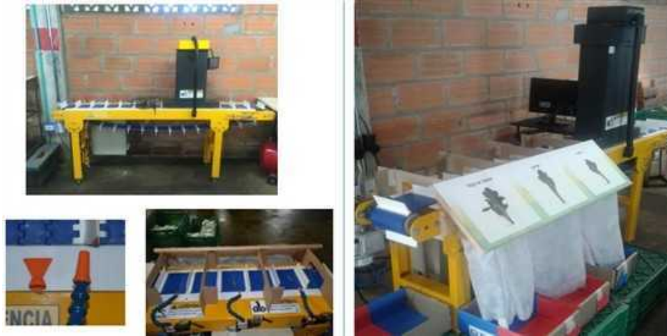
Figura 2.5: Ajustes de consolidación: configuración neumática (presión/boquilla) y elementos mecánicos (deflectores/tolvas) para estabilizar la expulsión y conducción hacia la salida.
