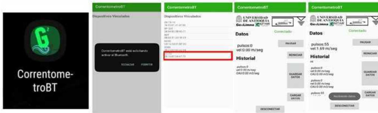
Figura 8.5: Secuencia general de uso del CorrentómetroBT : encendido del sistema, emparejamiento Bluetooth, recepción de datos y gestión de la medición en la aplicación móvil.
