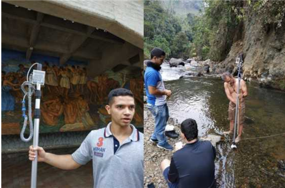
Figura 8.2: Contexto general de uso del CorrentómetroBT en labores de medición de flujo en campo. La figura busca resaltar el carácter aplicado del desarrollo y la necesidad de desacoplar el punto de sensado del punto de lectura para mejorar ergonomía y seguridad operativa.
