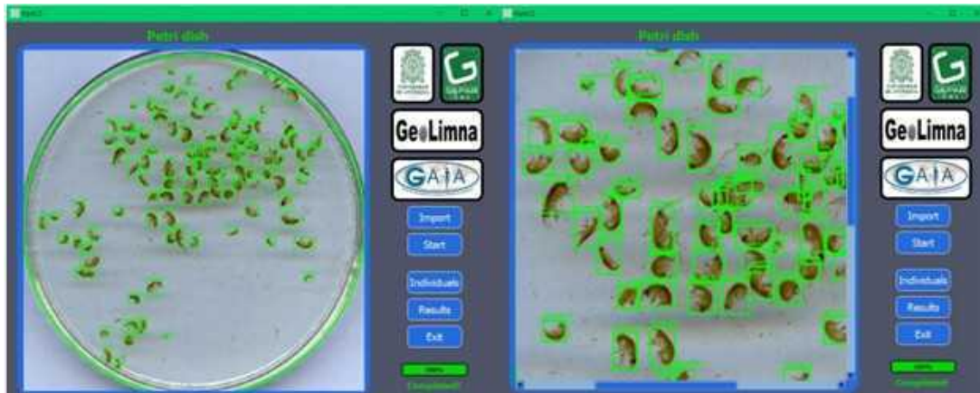
Figura 11.4: Resultado general del procesamiento en HyACS. Los rectángulos verdes indican la localización de individuos detectados dentro de la caja de Petri, permitiendo una auditoría visual del conteo automático.
